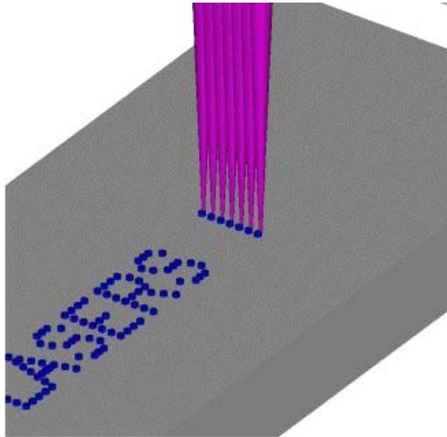
**Figure 6.4: Domino’s Seven-Tube Dot Matrix Coder**<sup>41</sup>
